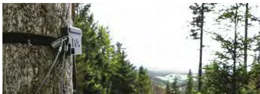
◀ Abb. 2 | Bei bioakustischen Erfassungen wird der Balzgesang der Waldschnepfe von Audiorecordern aufgezeichnet. An einen Baum befestigt können die Geräte für mehrere Monate autonom aufzeichnen. Die Störung von Lebensraum und Wildtieren bleibt dabei auf ein Minimum reduziert.
